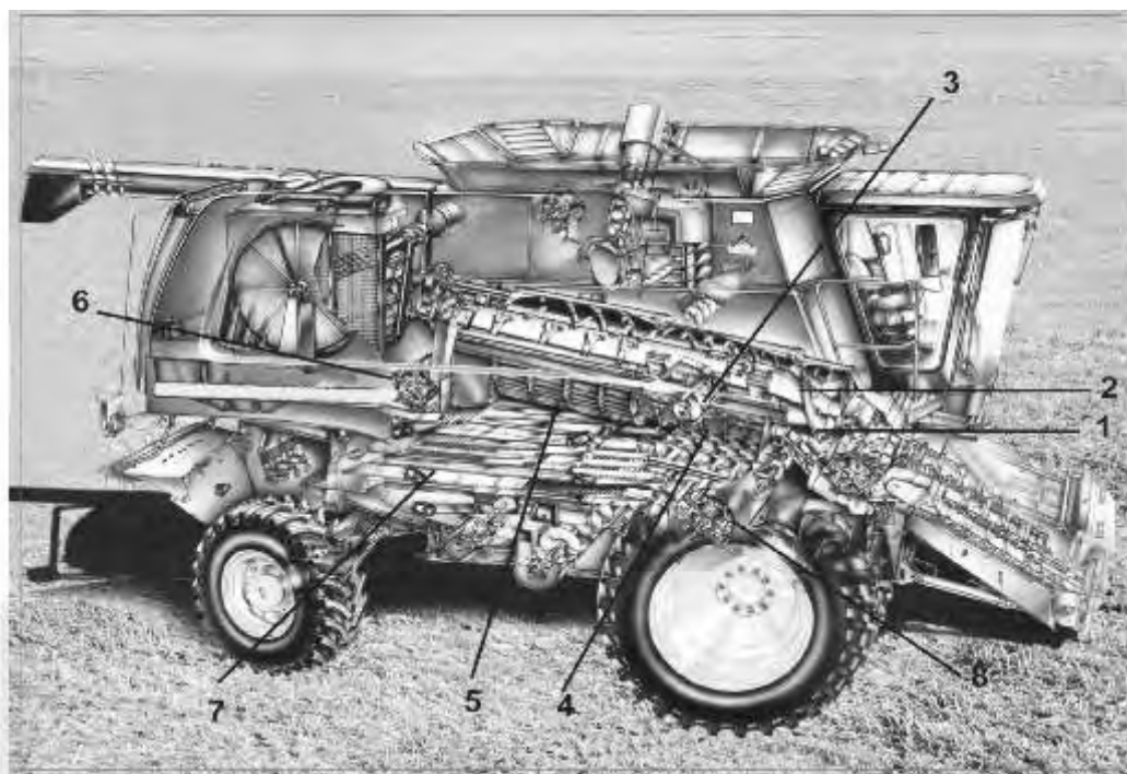
Figura 24: Cosechadora de flujo axial: 1) Cono de entrada; 2) Rotor; 3) Barras batidoras; 4) Cóncavos de trilla; 5) Cóncavos de separación; 6) Despajador de descarga; 7) Zarandas de limpieza; 8) Turbina de aire.
