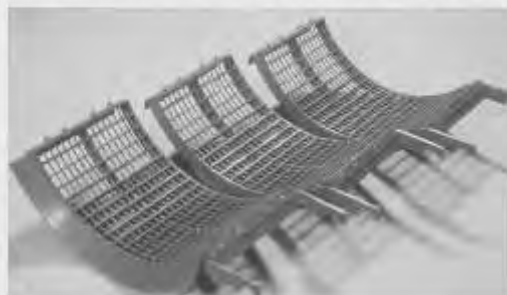
Figura 26: Cóncavos de trilla de la cosechadora axial (generalmente dispuestos en tres tramos)
